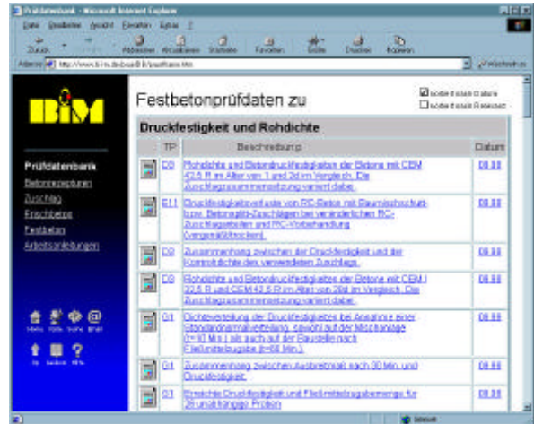
Abb.4a Die Prüfdatenbank von BiM-Online enthält die Ergebnisse aller im Forschungsvorhaben dokumentierter Materialprüfungen. Hier ein Teil der Auswahltabelle zu den Druckfestigkeitswerten am Festbeton.
